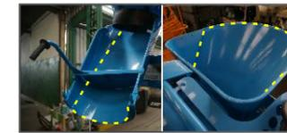
Chapas de Desgaste carga y descarga
