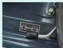
Palanca de retracción/extensión de oruga
