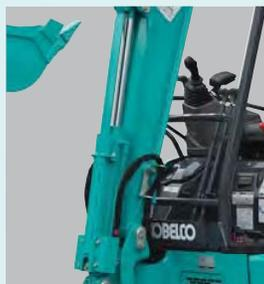
Protección del vástago del cilindro del brazo
