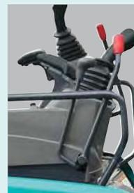
El bloqueo de seguridad de la palanca permite entrar y salir solamente cuando las palancas están desconectadas para prevenir la operación accidental.
