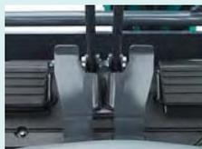
El pedal de desplazamiento simplifica las operaciones simultáneas mientras la máquina se desplaza.
