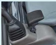
El descanso para la muñeca en cada caja de palanca de control garantiza un trabajo sin fatiga.
