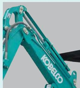
Protección del vástago del cilindro del cucharón
