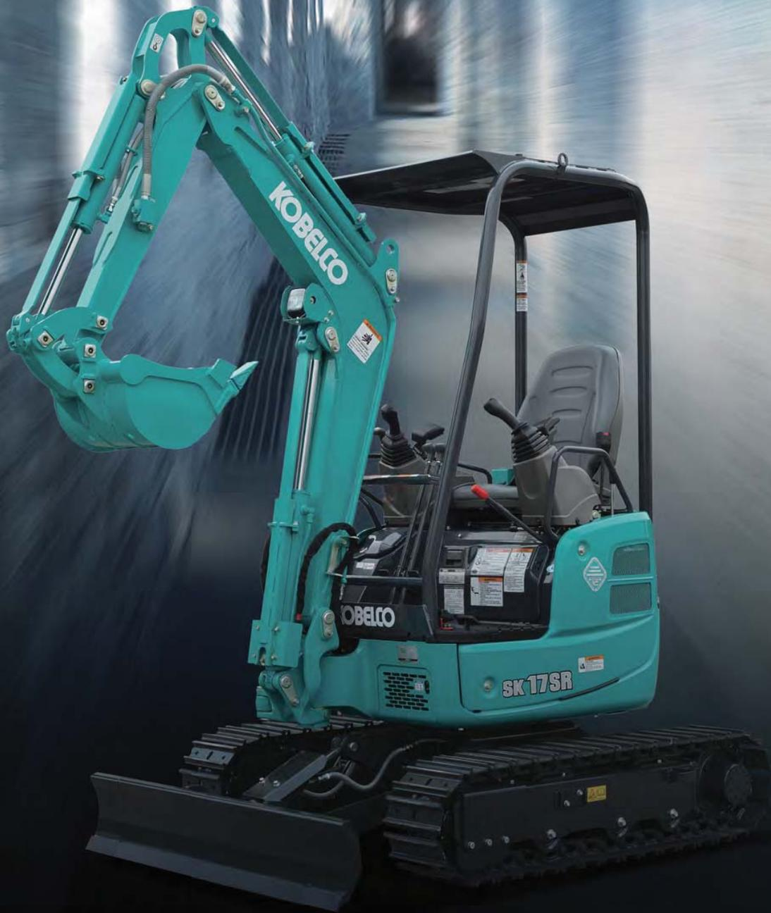
Las miniexcavadoras son muy utilizadas en lugares con espacio reducido, como áreas residenciales o instalaciones industriales, y en donde se necesita una máquina con mucha potencia, estabilidad de operación, construcción robusta y una durabilidad que reduzca el tiempo de inproductividad. La SK17SR combina un diseño compacto con un amplio alcance de excavación para ofrecer un desempeño eficiente, excelente maniobrabilidad y gran durabilidad para garantizar una vida útil prolongada.
