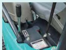
Palanca aceleradora del motor
